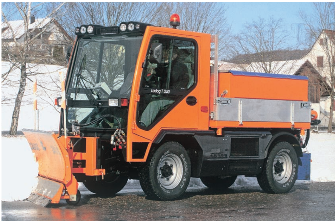
スノープラウと凍結防止剤 散布用荷台
