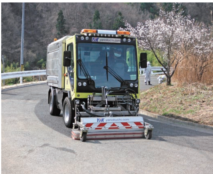
除染現場での道路洗浄車
